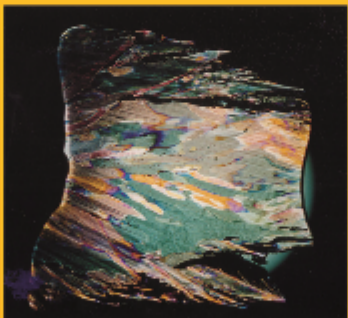
Secció fina del gel produït en un model de perfil aerodinàmic en condicions típiques de formació de gel. © Timothy Myers
